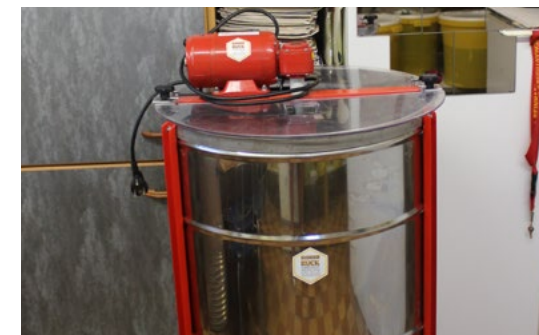
In einer solchen Honigschleuder wird mit Hilfe der Zentrifugalkraft der flüssige Honig aus den Bienenwaben gewonnen.
